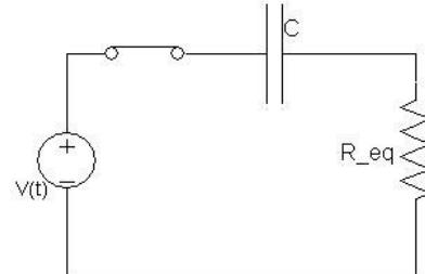
נעשה KVL:  $V(t) = V_C + V_R$  , נציב את הביטויים עבור זרם:  $V(t) = V_C + V_R$
